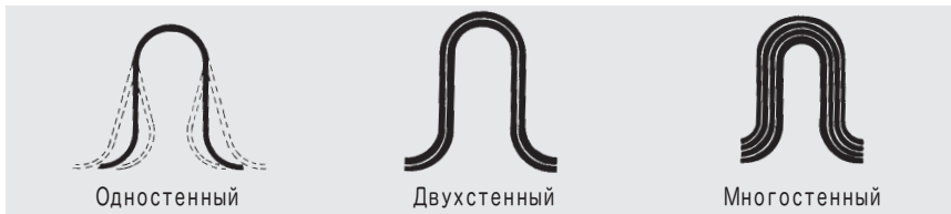
При значительных вибрациях применяются многостенные сильфоны
